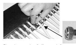
Placez le couvercle métallique sur la face inférieure du boîtier et serrez les vis.
